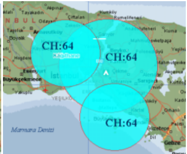
Şekil 10-b) Dijital yayıncılıkta SFN uygulaması
